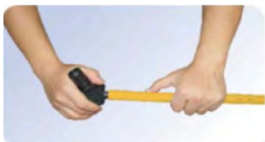
2.- Aborcardar y Redondear 2.- Abocardar e Arredondar
