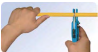
1.- Corte de tubo 1.- Cortar o tubo
